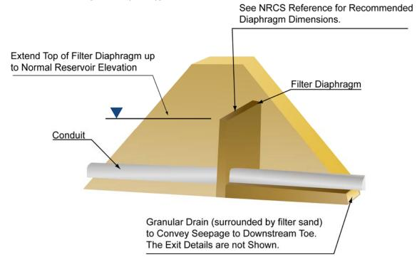
Figure 14 - Conduit Filter Diaphragm Collar
